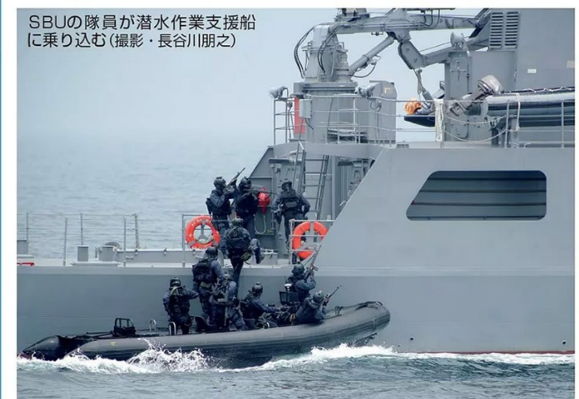
特別機動船。船体上部はゴムだが、船底は堅牢なFRP製。時速70km以上の高速で相手船舶に接近。ヘルメットの上には救難用ストロボライトを載せ、折りたたみ式の89式小銃を構える
