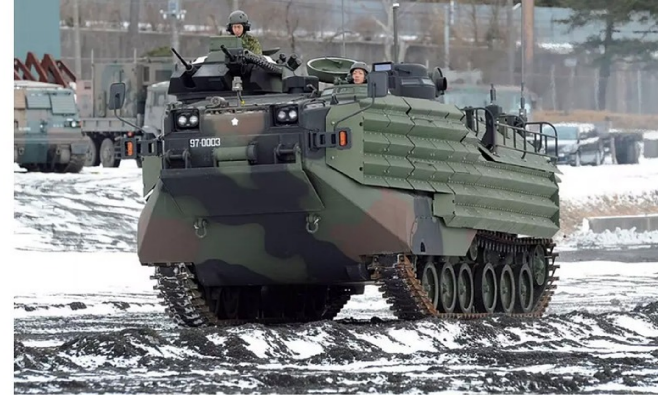
水陸両用強襲輸送車AAV7。陸上では時速70km、水上でも時速13kmで走る
